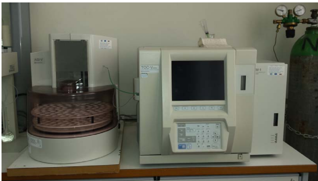
Εικόνα 3.6: Όργανο TOC V-CSN, TN με αυτόματο δειγματολήπτη της εταιρείας Shimadzu.
