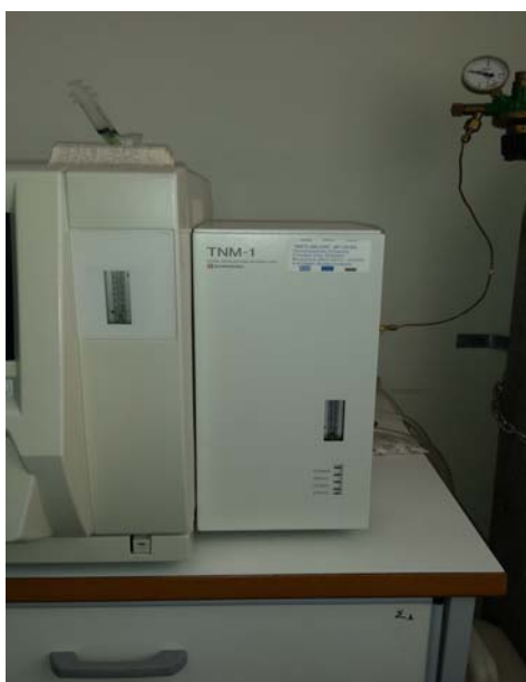
Εικόνα 3.7: TNM-1, Σύστημα μέτρησης Ολικού Αζώτου, της εταιρείας Shimadzu.
