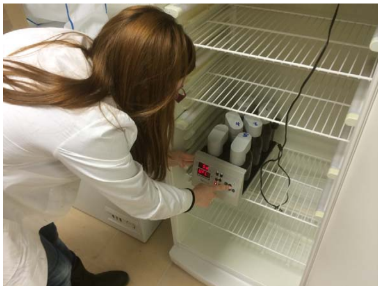
Εικόνα 3.3: Συσκευή μέτρησης BOD
