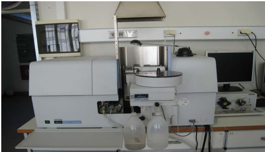
Εικόνα 3.9: Φασματοσκοπία Ατομικής Απορρόφησης AAS, AA800 της εταιρείας Perkin Elmer.
