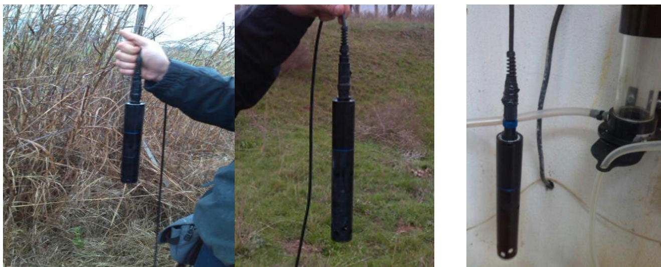
Εικόνα 3.2: Πολύμετρο μέτρησης φυσικοχημικών παραμέτρων στο πεδίο, της εταιρείας AquaRead.
