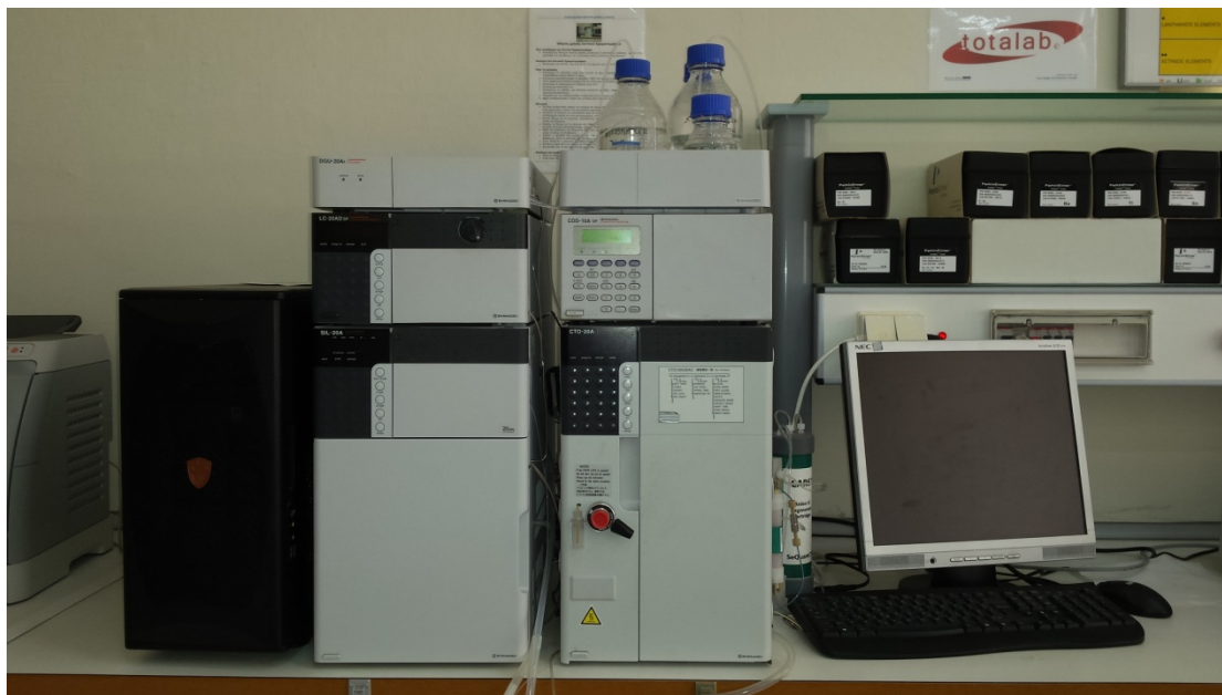
Εικόνα 3.8: Ιοντικός χρωματογράφος της εταιρείας Shimadzu με αυτόματο δειγματολήπτη
